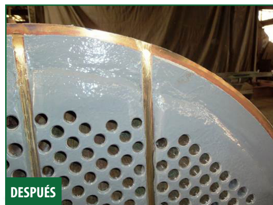
Lámina de tubo revestida con Novocoat EP5700 Ceramic Paste.
