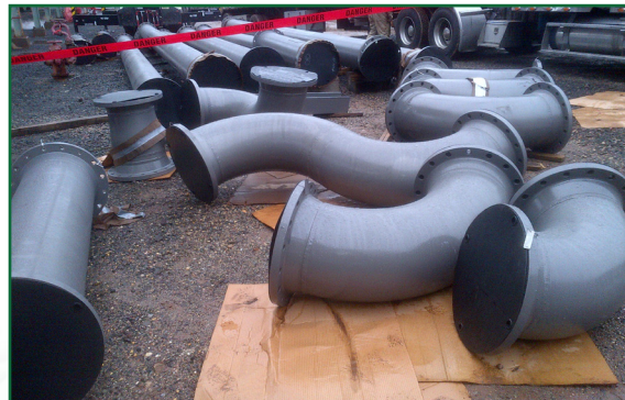
Novocoat DTM Epoxy aplicado en el exterior. Novocoat SC3300 Novolac Epoxy Lining aplicado en el interior.
